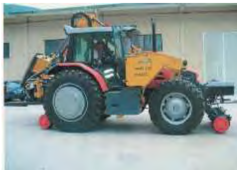
Fig. n.10 Trattore decespugliatore strada rotaia per sfalcio meccanico
