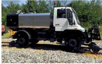
**Fig. n.7 Mezzo strada rotaia Unimog U405 per diserbo chimico e per il trattamento igniritardante**
