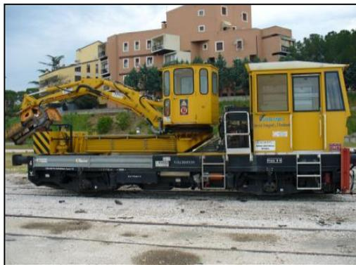
Fig. n.9 Autocarrello Decespugliante Cometi
